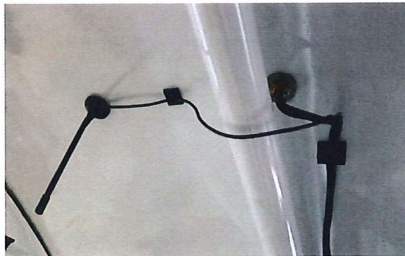
Antennen är monterad i centrum av taket, vilket är att föredra.
